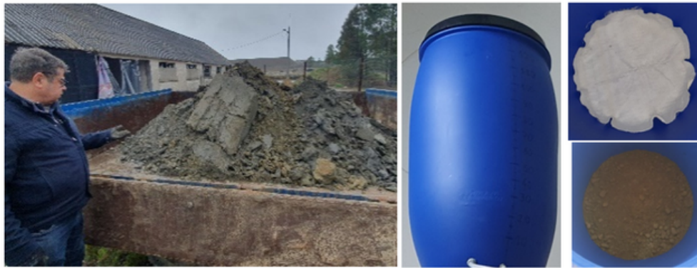
Figura 2: Steril brut colectat din bazinul 2a al minei Panasqueira și alimentat în pilotul de procesare AMD (200 kg steril).
